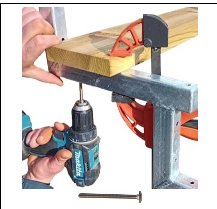
5b - Fíjala con sargentos, taladra la tabla desde abajo a través de los agujeros de la zanca e inserta los tornillos con un martillo (las tuercas todavía no).
