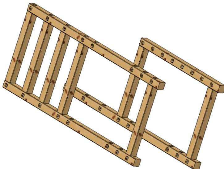
4. Fixer les traverses (numérotées 62/82/102/122/142 en fonction de la largeur de l'escalier) entre les poteaux C et D à l'aide des vis Retinox 8x120 mm (veuillez consulter le plan de montage).
