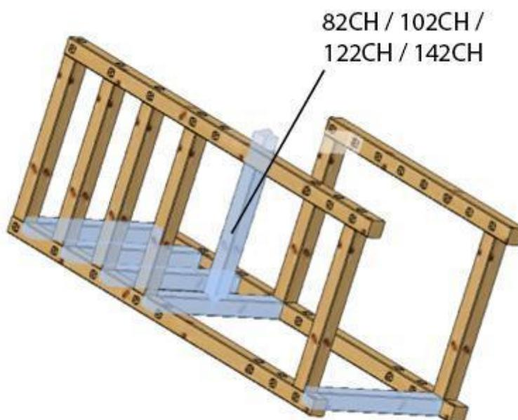
5. Fixer les traverses entre les poteaux A et B avec les vis Retinox 8x120 mm. Veuillez consulter l'image ci-dessous pour repérer l'emplacement de la traverse marquée ST. Cette traverse est pré-percée. Positionner les trous en face et à l'intérieur de la structure. Astuce : tourner les vis de quelques millimètres seulement, une fois toutes les traverses en place, les serrer complètement.
